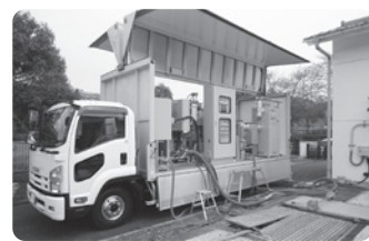
▲新しく購入した汚泥脱水乾燥車
