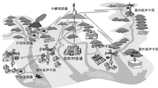
防災行政無線のイメージ。自治体に設置された親局から、中継局、屋外拡声子局を通じて、戸別受信機へ配信される(出典:総務省消防庁)
