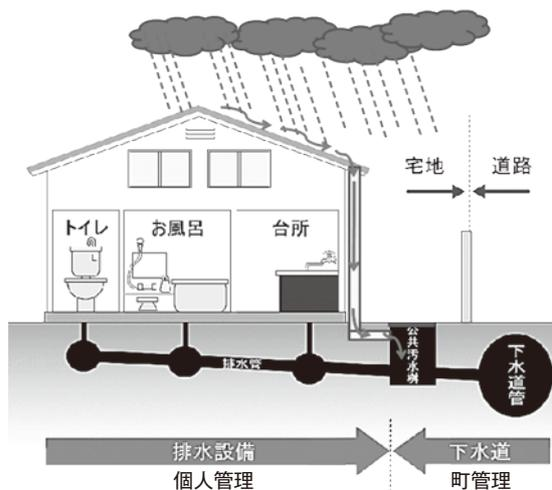
不明水とは下水道の枳や管に流れ込む雨水や地下水のことを言います。不明水が下水処理施設に多量に流れ込むと適正な処理ができなくなる上、下水処理費用が増加してしまいますので、町では下水道管の調査や修繕などを行っています。不明水の原因は、汚水枳に誤って雨桶の接続をしている場合や、宅内枳や公共汚水枳が破損して雨水が流入している可能性があります。不明水削減のために、ご確認ください。お願いします。
